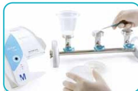
4. 過濾結束後，用鑷子將膜取下，放入培養基中
