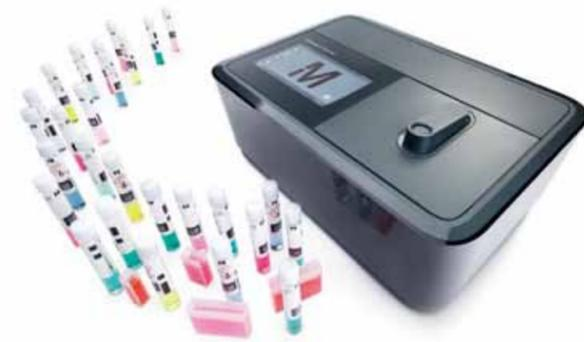
**Spectroquant® 測試試劑組**
